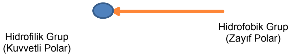
Şekil 1: Bir Yüzey Aktif Maddenin Şematik Görünümü
